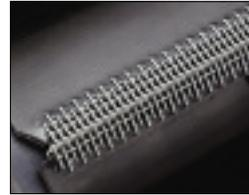
El diseño escalonado proporciona una enorme fuerza de sujeción a los ganchos de alambre sin disminuir la integridad del armazón de la banda. Los empalmes de hoy también tienen un muy bajo perfil, incrementando su compatibilidad con los componentes del transportador y necesidades de reducir el ruido en la operación.
