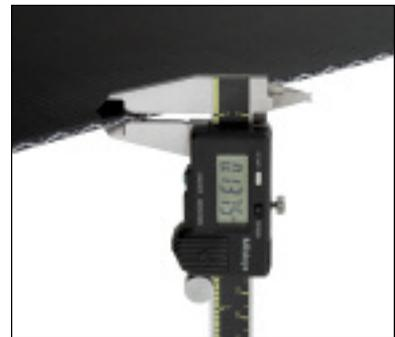
*Medidor de espesor de banda.*
