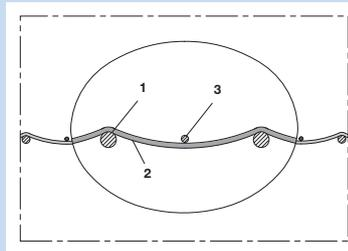
Hochtemperatur Absaug- und Gebläseschlauch; Silikon, einlagig, dicht, hochflexibel (bis 260°C)
